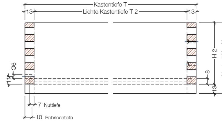
Bohrungen zur Blendenbefestigung optional !
