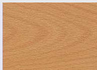
gedämpfte Buche leicht gedämpft, min. 6 Monate vorge- trocknet für wenig Verzug
